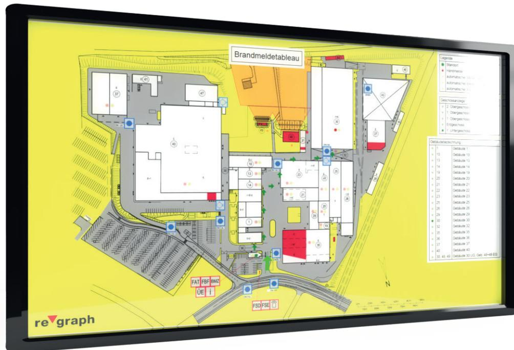
Mit dem digitalen Brandmeldetableau lassen sich Gebäudegrundrisse, Lagepläne und Alarmmeldungen einer Brandmeldeanlage, rein softwarebasiert auf Monitoren sowie auf mobilen Endgeräten anzeigen. Nutzungs- und Grundrissänderungen können somit schnell und einfach eingearbeitet werden.
