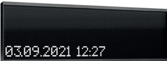
Das Großdisplay wird durch einen APLIST™-Datenserver betrieben. Es werden die Meldungstexte dargestellt, die im APLIMO™-System auch zur Anzeige an Feuerwehr-Anzeigetableaus (FAT) verwendet werden. Es können mehrere Großdisplays hintereinander betrieben werden.
